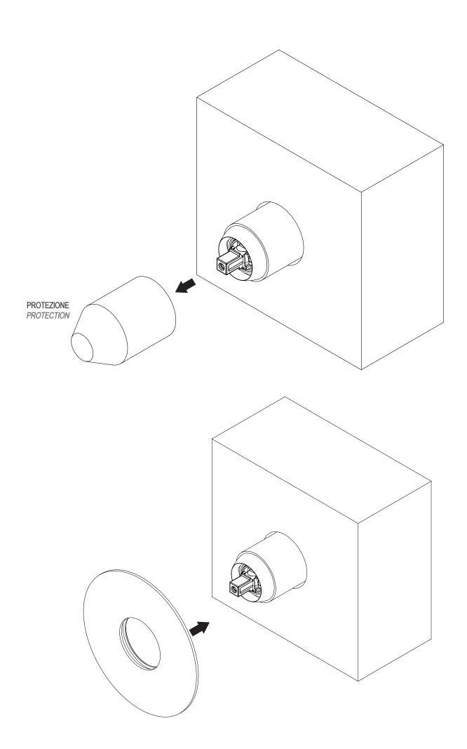
Inserire la leva sulla cartuccia, serrare il grano della leva con apposita chiave a brugola, inserire il tappino copriforo.
