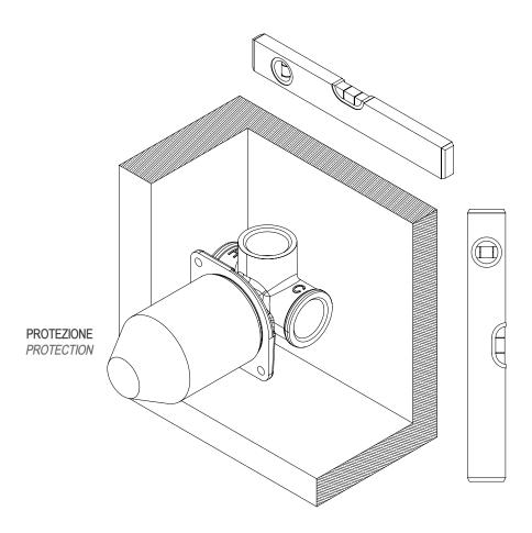
Effettuare l'allacciamento alla rete idrica seguendo lo schema sotto riportato. Collegare poi l'uscita al prodotto acquistato. Ultimati i collegamenti procedere con la prova dell'impianto.
