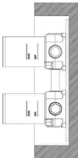
Creare una nicchia nel muro in modo tale che, una volta fissato il box incasso al suo interno, il bordo del muro finito e piastrellato sia compreso tra le due linee MIN & MAX stampate sul box incasso.
