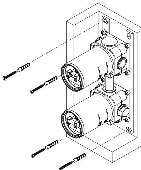
Fissare il box incasso al muro con quattro viti e tasselli da 6mm tramite piastra di ancoraggio.
