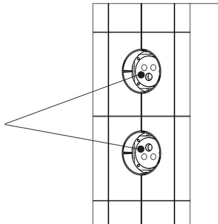
Installare le parti esterne serrando le viti al corpo incasso. Sarà necessaria una chiave a brugola di misura 2.5.
