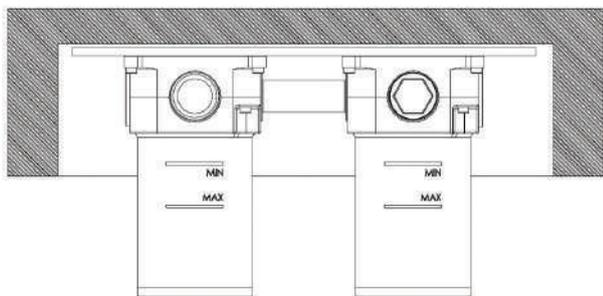
Creare una nicchia nel muro in modo tale che, una volta fissato il box incasso al suo interno, il bordo del muro finito e piastrellato sia compreso tra le due linee MIN & MAX stampate sul box incasso.
