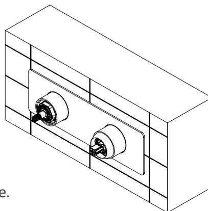
Assemblare le due leve. Sarà necessaria una chiave a brugola di misura 2.5.
