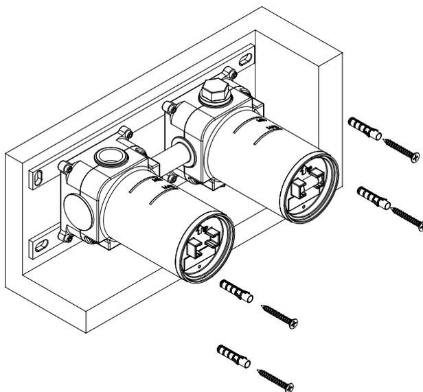
Fissare il box incasso al muro con quattro viti e tasselli da 6mm tramite piastra di ancoraggio.
