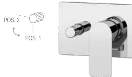
I09HRG Miscelatore a incasso per vasca/doccia con deviatore a 2 vie con vitone ceramico, su piastra rettangolare, montaggio orizzontale. Per selezionare l'uscita desiderata, la manopola del deviatore deve essere ruotata da una posizione all'altra. Built-in bath/shower mixer with 2-way diverter with ceramic head valve, on rectangular plate, horizontal mounting. To select the desired output, the diverter knob must be turned from one position to the other.
