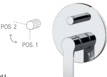
EY09H Miscelatore a incasso per vasca/doccia con deviatore a 2 vie a vitone ceramico, su piastra tonda. Per selezionare l'uscita desiderata, la manopola del deviatore deve essere ruotata da una posizione all'altra. Built-in bath/shower mixer with 2-way diverter with ceramic head valve, on round wall plate. To select the desired output, the diverter knob must be turned from one position to the other.
