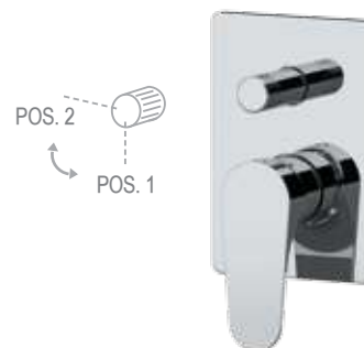
L09HG Miscelatore a incasso per vasca/doccia con deviatore a 2 vie a vitone ceramico, su piastra rettangolare. Per selezionare l'uscita desiderata, la manopola del deviatore deve essere ruotata da una posizione all'altra. Built-in bath/shower mixer with 2-way diverter with ceramic head valve, on rectangular wall plate. To select the desired output, the diverter knob must be turned from one position to the other.
