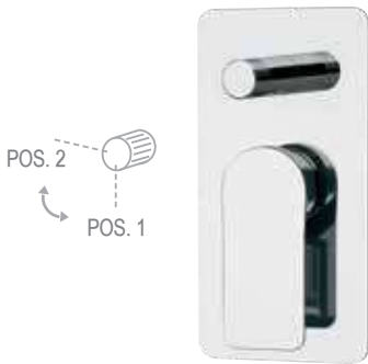
I09HL Miscelatore a incasso per vasca/doccia con deviatore a 2 vie a vitone ceramico. Per selezionare l'uscita desiderata, la manopola del deviatore deve essere ruotata da una posizione all'altra. Built-in bath/shower mixer with 2-way diverter with ceramic head valve. To select the desired output, the diverter knob must be turned from one position to the other.
