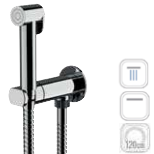
N64W Miscelatore shut-off con cartuccia progressiva, apertura su acqua fredda e passaggio ad acqua calda tramite rotazione di maniglia unica, comprensivo di doccetta shut-off e flessibile doccia cm 120. Shut-off mixer with progressive cartridge, opening with cold water, switching on hot water by rotating one single handle including shut-off and shower flexible 120 cm.
