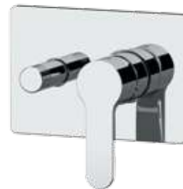
W09HRG Miscelatore a incasso per vasca/doccia con deviatore a 2 vie con vitone ceramico, su piastra rettangolare, montaggio orizzontale. Per selezionare l'uscita desiderata, la manopola del deviatore deve essere ruotata da una posizione all'altra. Built-in bath/shower mixer with 2-way diverter with ceramic head valve, on rectangular plate, horizontal mounting. To select the desired output, the diverter knob must be turned from one position to the other.
