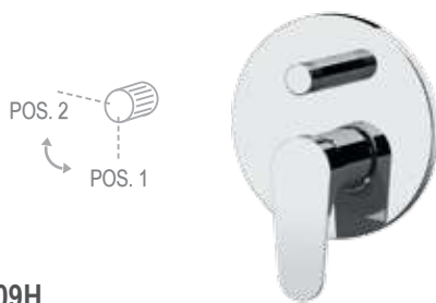
L09H Miscelatore a incasso per vasca/doccia con deviatore a 2 vie a vitone ceramico, su piastra tonda. Per selezionare l'uscita desiderata, la manopola del deviatore deve essere ruotata da una posizione all'altra. Built-in bath/shower mixer with 2-way diverter with ceramic head valve, on round wall plate. To select the desired output, the diverter knob must be turned from one position to the other.
