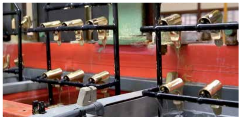
Grande impianto interno per la cromatura decorativa Big internal plant for decorative chrome plating
