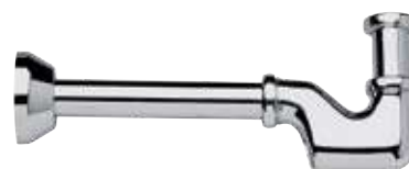
Sifone fuso pesante lusso in ottone, per lavabo e bidet 1", 1" 1/4 canotto cm 30. Brass luxury "P" trap, heavy type, 1", 1" 1/4, outlet tube cm 30.
