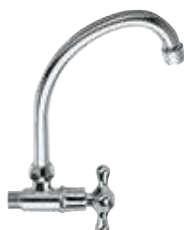
Rubinetto a snodo pesante, 1/2" canna alta "J", Ø 18, con canna girevole e rompigetto. Sink tap 1/2", with high "J" swivel spout Ø 18 and aerator.
