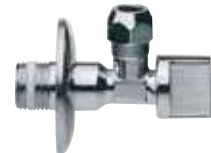
Rubinetto a sfera con guarnizione in PTFE, con calotta e rosetta in ottone cromato, 1/2x10. C.P. brass ball valve with PTFE washer and flange, 1/2x10.
