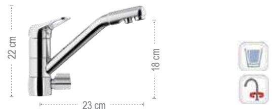
K40DW Miscelatore lavello a tre vie di ingresso con bocca girevole, con selezione acqua potabile tramite la leva, con 2 aeratori in uscita. Three ways inlet single lever sink mixer, with swivel spout, with selection for drinking water directly from the lever, with 2 exit aerators.
