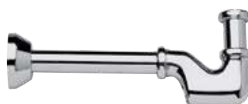
Sifone fuso pesante lusso in ottone cromato, per lavabo e bidet 1", 1" 1/4 canotto cm 30. C.P. brass luxury "P" trap, heavy type, 1", 1" 1/4, outlet tube cm 30.
