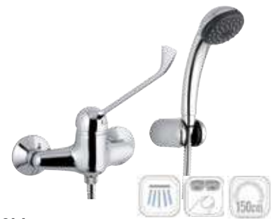
K39LL Miscelatore monocomando esterno doccia con leva lunga, con doccetta in ABS anticalcare ad 1 funzione e supporto snodato flessibile 150 cm. Wall mounted single-lever shower mixer with long lever, with 1 function antilimestone ABS handshower and swivel shower holder, flexible hose 150 cm.
