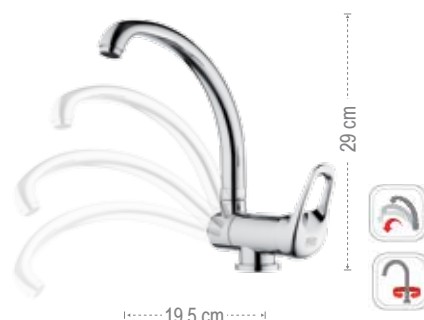
R42R Miscelatore monocomando monoforo 90° per lavello, con bocca alta girevole ed abbattibile, tipo lusso, modello sottofinestra. Single-lever one-hole sink mixer, with high swivel and foldable spout, luxury type, under window type.
