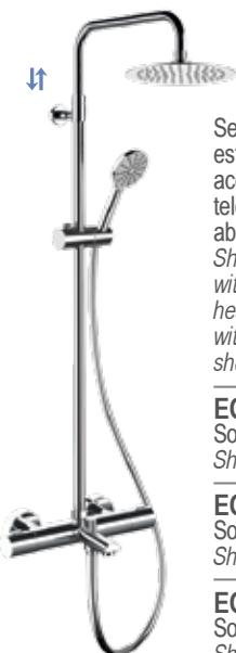
Set doccia composto da: miscelatore termostatico esterno con deviatore vasca/doccia, soffione in acciaio inox 357UFM20X, colonna doccia in ottone telescopica, altezza asta regolabile 329A, doccetta in abs con 4 funzioni 318MP, flessibile 150 cm.
