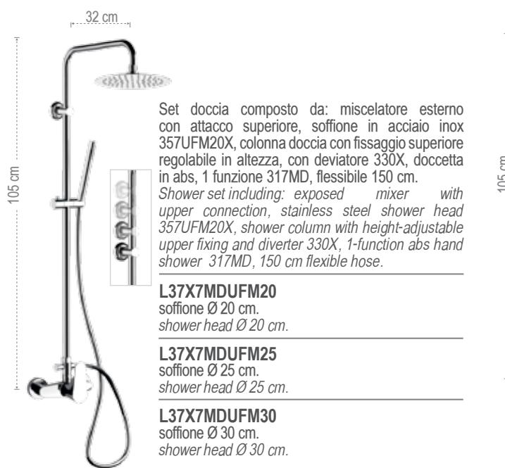
Set doccia composto da: miscelatore esterno con attacco superiore, soffione in acciaio inox con angoli arrotondati 357UDF20X, colonna doccia con fissaggio superiore regolabile in altezza, con deviatore 330X, doccetta quadrata in ABS, 1 funzione 317SD, flessibile 150 cm.
