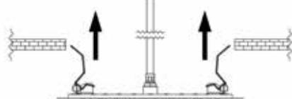
Per questa tipologia di soffione e con questo specifico sistema di fissaggio sono previste quattro molle per ogni soffione.
