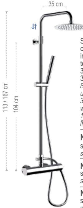
Set doccia composto da: miscelatore esterno con attacco superiore, soffione in acciaio inox 357UFM20X, colonna doccia in ottone telescopica, altezza asta regolabile, con deviatore 330A, doccetta minima in ottone, 1 funzione 317MM, flessibile 150 cm.
