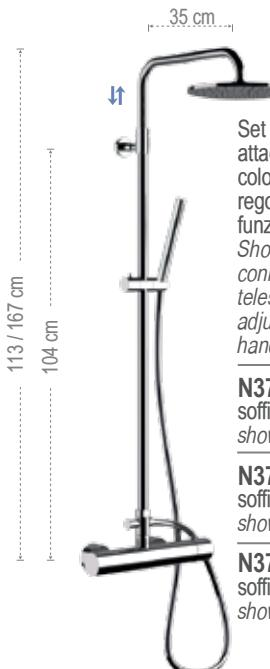
Set doccia composto da: miscelatore esterno con attacco superiore, soffione in abs 356MD20X, colonna doccia in ottone telescopica, altezza asta regolabile, con deviatore 330A, doccetta in abs, 1 funzione 317MD, flessibile 150 cm.
