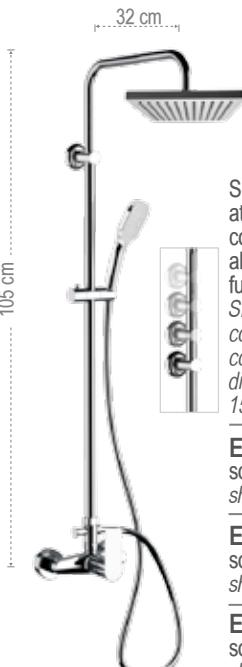
Set doccia composto da: miscelatore esterno con attacco superiore, soffione in abs 356SD20X, colonna doccia con fissaggio superiore regolabile in altezza, con deviatore 330X, doccetta in abs con 4 funzioni 318CP, flessibile 150 cm.
