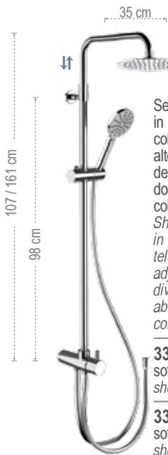
Set doccia composto da: soffione tondo ultrapiatto in acciaio inox lucidato a specchio 357UFM20X, colonna doccia in ottone telescopica, con asta ad altezza regolabile 329A; supporto colonna con deviatore integrato e presa acqua inferiore 330NRA; doccetta in abs 4 funzioni 318MP; flessibile 50 cm per collegamento esterno, 1/2Fx1/2F; flessibile 150 cm.
