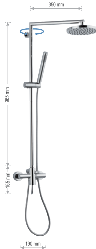
J 37 B Miscelatore esterno doccia con deviatore integrato, con colonna saliscendi girevole, completo di doccetta anticalcare con flessibile e soffione 356MD20 in abs cromato, Ø 20 cm.
