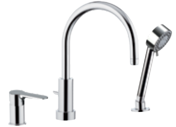
W 07 Miscelatore monocomando bordo vasca con deviatore a leva, bocca minimale e doccetta in ABS cromato a 4 funzioni. Single lever deck bath mixer with lever diverter, with minimal spout and 4 functions chrome plated ABS hand shower.
