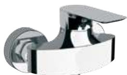
IC31 Miscelatore monocomando esterno doccia, interasse 10 cm per shut-off, senza kit doccia. Shut-off wall mounted single lever shower mixer, interaxis 10 cm, without shower kit.
