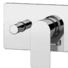
I09HRG Miscelatore a incasso per vasca/doccia con deviatore a 2 vie con vitone ceramico, su piastra rettangolare, montaggio orizzontale. Per selezionare l'uscita desiderata, la manopola del deviatore deve essere ruotata da una posizione all'altra. Built-in bath/shower mixer with 2-way diverter with ceramic head valve, on rectangular plate, horizontal mounting. To select the desired output, the diverter knob must be turned from one position to the other.
