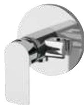
I65B Miscelatore incasso per shut-off con supporto doccia/presa acqua integrato, attacco conico da 1/2", tutto in ottone, senza kit doccia. Built-in shower mixer with integrated shower holder/water punch on flange all in brass, with 1/2 connection, without shower kit.
