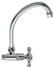
Rubinetto a snodo pesante, 1/2" canna alta "J", Ø 18, con canna girevole e rompigetto. Sink tap 1/2", with high "J" swivel spout Ø 18 and aerator.
